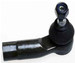
KP-VW-04041 TIE ROD END 1K0 423 812 A L=99 mm T1=M12X 1.5 T2=M16X 1.5 GOLF V
