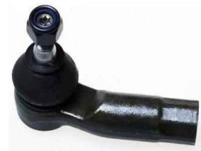
KP-VW-04040 TIE ROD END 1K0 423 811 A L=99 mm T1=M12X 1.5 T2=M16X 1.5 GOLF V
